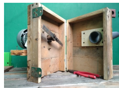
Gambar 2. Konstruksi Mesin Pencacah Rumput
