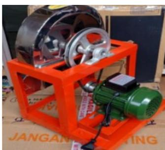
Gambar 2. Mesin Pengiris Aneka Keripik
