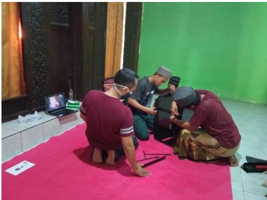
Gambar 6 Proses perakitan kaki mesin (rumah motor)
