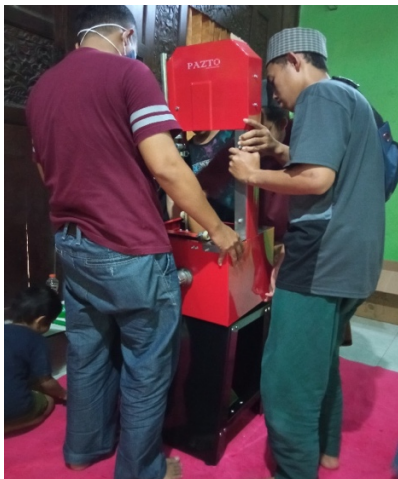
Gambar 7 Proses perakitan kaki mesin (rumah motor)
