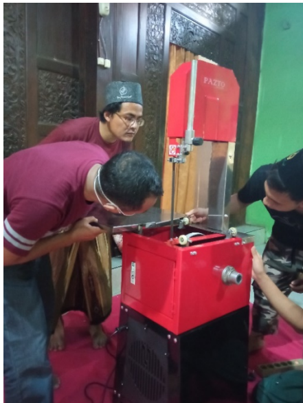
Gambar 10 Proses pemasangan meja geser
