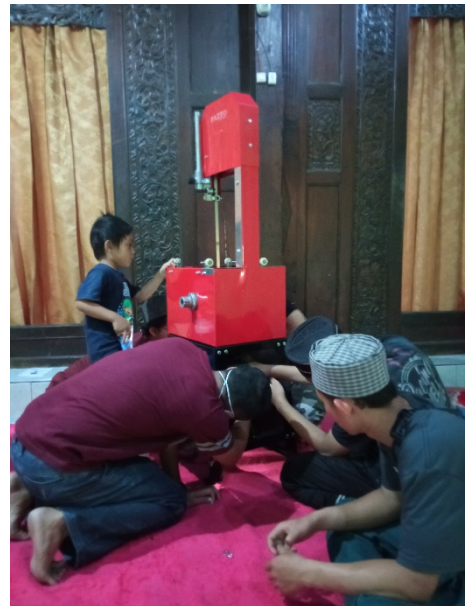
Gambar 8 Proses pemasangan motor penggerak
