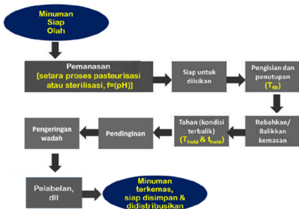
Gambar 3 Skema metode hot filling
