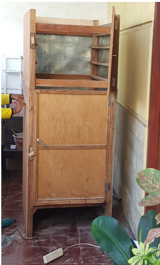
Gambar 8 Pintu oven sudah dirubah dengan system buka tutup seperti pintu rumah.
