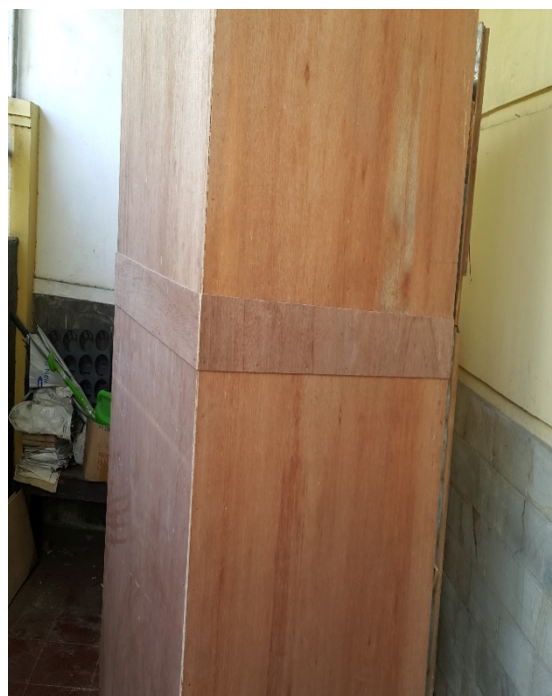
Gambar 12 Perapat antara oven dengan triplek
