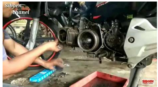
Gambar 7. Melepas Busi dan Kabel
