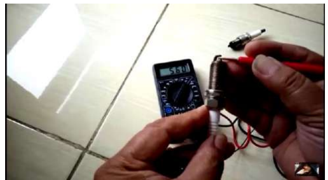
Gambar 8. Mengukur Tahanan Busi
