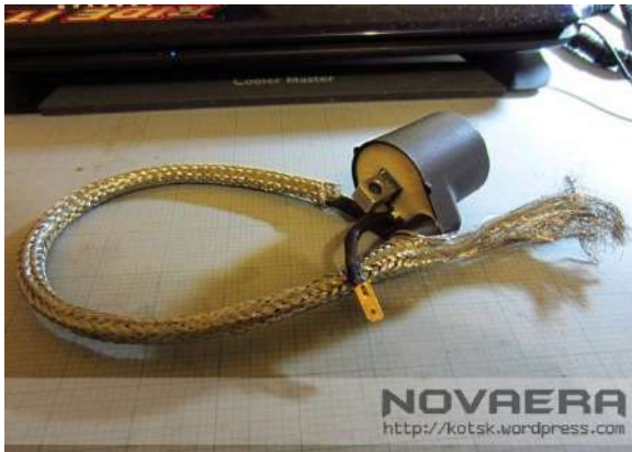
Gambar : 4 . Membungkus kabel busi dengan ground strap
