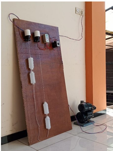
Gambar 2. Rangkaian jadi kontrol pompa.
