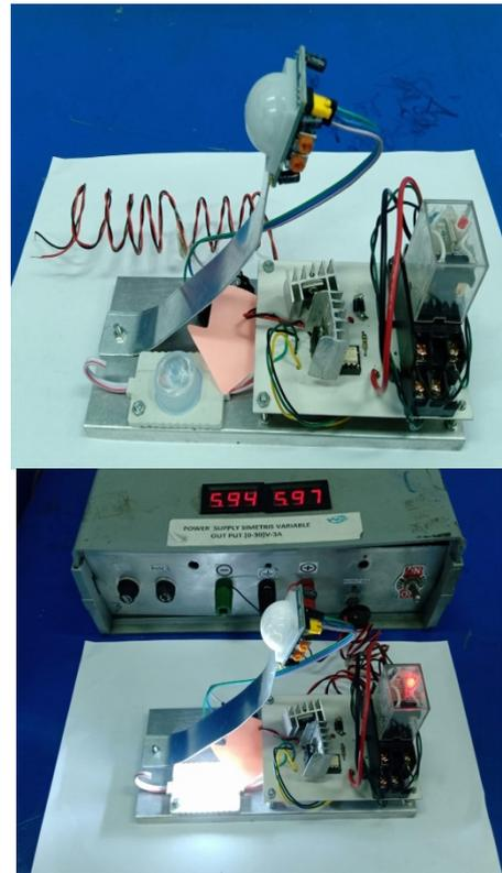
Gambar 8. Hasil Pengujian Rangkaian otomatis dengan sensor PIR dengan lama lampu menyala beberapa detik
