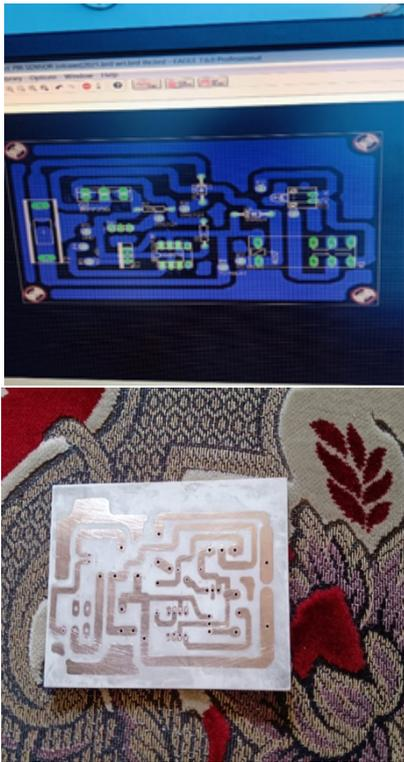
Gambar 6. Disain dan proses PCB rangkaian otomatisasi
